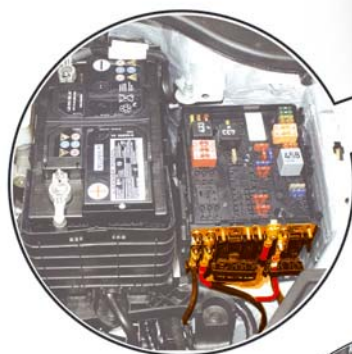
Vorsicherungs-Box im Motorraum links
