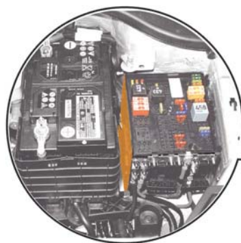
Zusatzrelaisträger unter der Sicherungs- und Relaisbox
